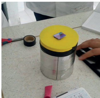
Figura 24. Montaje para ver su voz. Fuente: los autores.
