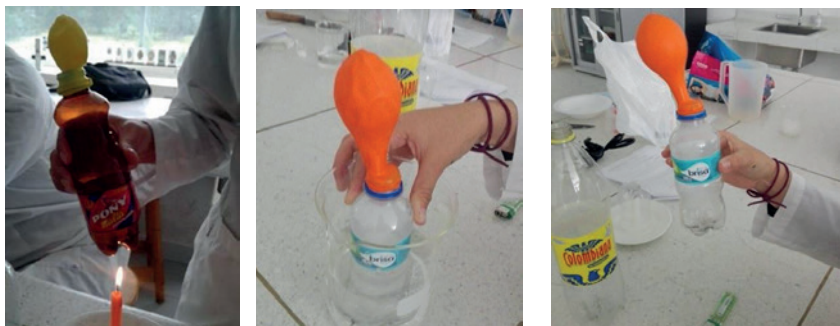
Figura 28. Comprobación de la ley de Charles. Fuente: los autores.
