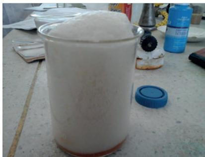
Figura 6. Reacción de la sangre con el agua oxigenada. Fuente: los autores.
