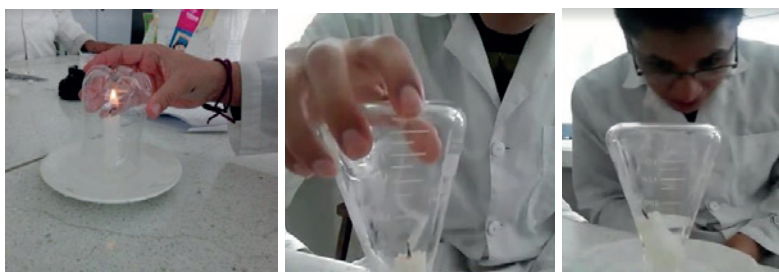
Figura 27. Procedimiento sobre comprobación de la ley de Gay-Lussac. Fuente: los autores.
