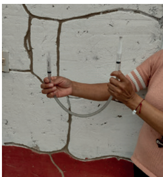
Figura 30. Montaje para explicar el principio de Pascal. Fuente: los autores.
