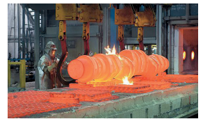
Fig 2.106 Tratamiento térmico de temple
