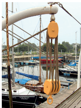
Fig 5.28 Polea móvil para levantamiento de cargas pesadas.
