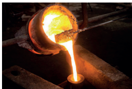
Fig 2.104 Proceso de colabilidad en metales.
