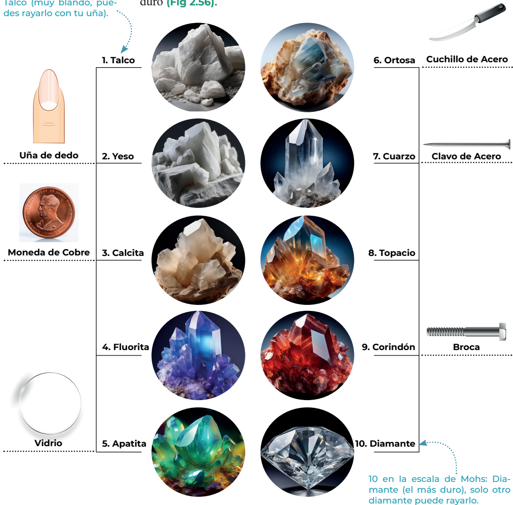
Fig 2.56 Escala de dureza de Mohs.
