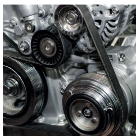
Fig 5.40 Sistema de poleas con correa móvil en motor de carro.
