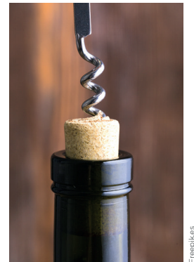
Fig 4.49 Su longitud transversal no varía si se aplica un esfuerzo.
