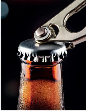
Fig 5.11 Para destapar una cerveza se requiere hacer palanca con un destapador.
