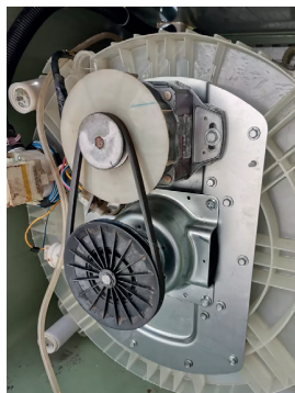
Fig 5.39 Sistema de poleas con correa móvil en lavadora.
