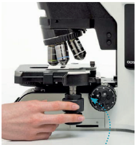
Fig 5.79 Sistema de control de precisión de enfoque con piñón cremallera.
