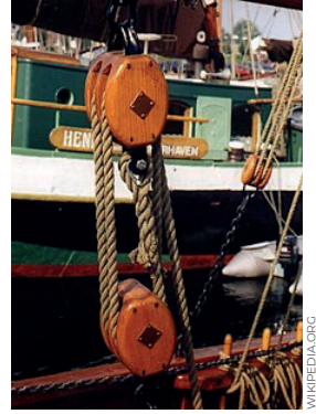
Fig 5.32 Sistema de polea móvil para embarcaciones.
